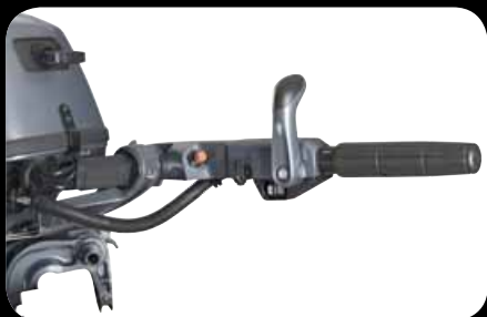
Förlängd rorkult med gas, växel och nödstopp. De manuella modellerna har bränsleinsprutning som inte kräver ett batteri.
